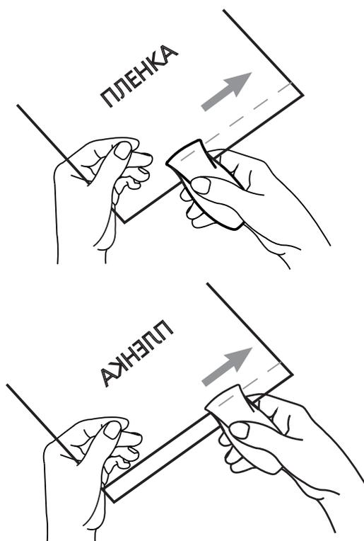
Вы также можете склеивать поверхности пленок или пакеты не полностью, оставив незаклеенным промежуток рядом с одним из краев пленки. Это удобно для контролируемого извлечения из пакетов сыпучих веществ или для доступа воздуха.
